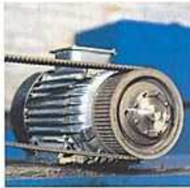
Système de transmission poulie-courroie
